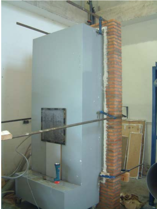
Foto 9: Banco de ensayos de resistencia al agua de lluvia
